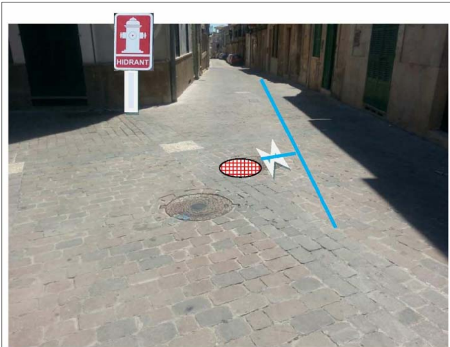
HIDRANT Nº 1 (adaptar racrods i senyals a paret. Tapa vermella i clau)
