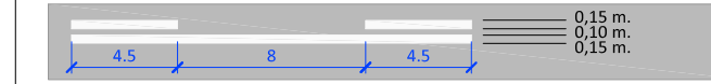
M-3.2 ORDENACIÓ DE L'ADELANTAMENT EN CALÇADA DE DOBLE SENTIT DE CIRCULACIÓ PER A VÍES AMB 50 Km/h < VMmax ≤ 100 Km/h
